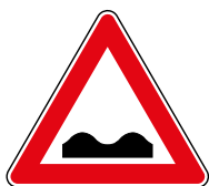
FIG. 1 ART. 85 STRADA DEFORMATA
