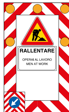
FIG. 1 ART. 39 PRESEGNALIZZAZIONE OPERAI AL LAVORO
