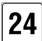
FIG. 267 ART. 129 PROGRESSIVA DISTANZIOMETRICA PER STRADA PROVINCIALE
