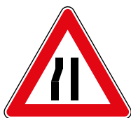
FIG. 18 ART. 90 STRETTOIA ASIMMETRICA A SINISTRA
