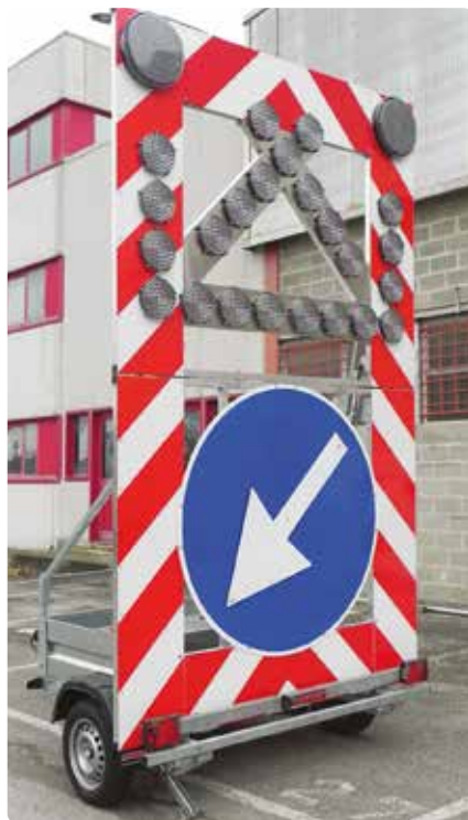
Rimorchio Fig. 401 "Protezione cantieri stradali"
